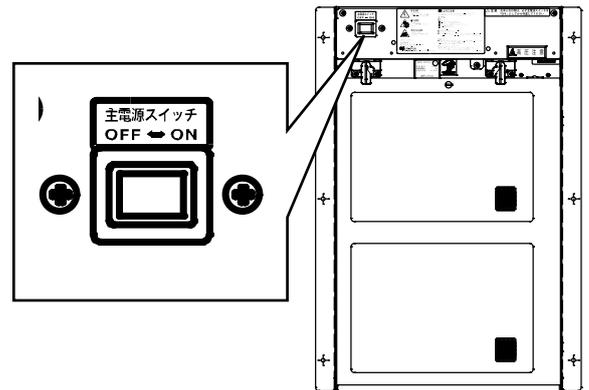
手順5 埋込表示スイッチの入切スイッチを1度「OFF」にしてから「ON」にしてください。
