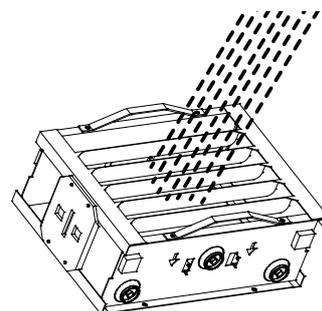
**手順3** 電子式集塵フィルタの水を切ります。その際は強く振って水を切らないでください。
